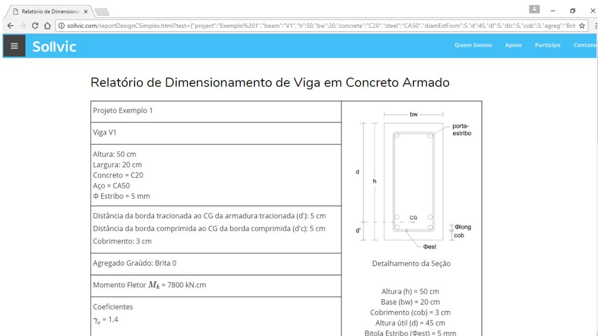
Relatório de Dimensionamento de Viga em Concreto Armado
